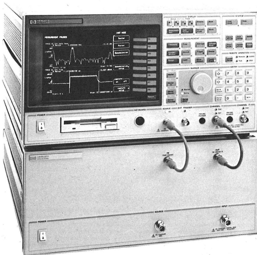
HP 89440A Vektor-Signalanalysator, 0 bis 1,8 GHz
